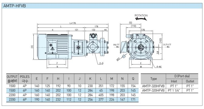
In, Outlet - FAVB : Front side 흡입, 토출구 전면에 위치 HFVB: Ether side 좌우측에 위치
