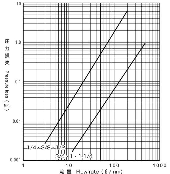
試験条件 流体：ISO VG 32 (タービン油) 温度：40 粘度：32c.s.t
