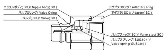
残圧下での接続が可能なPHバルブ機構を採用しています。7.0MPaの残圧下でも17.7Nで接続できます。
