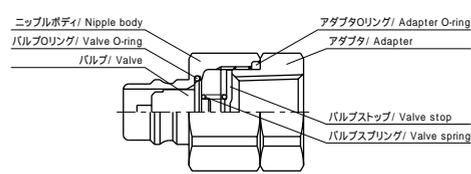
開閉式バルブ機構を備えたタイプです。 It is a type having open-shut valve mechanism.
